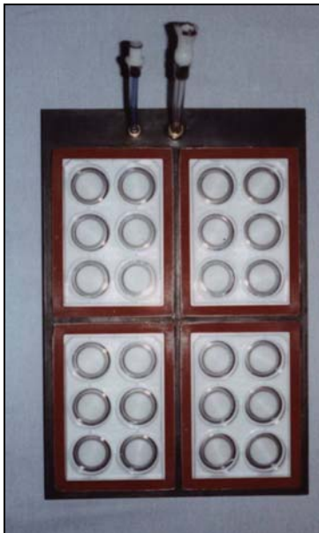
図 3. スタンダード型BioFlex® ベースプレート
