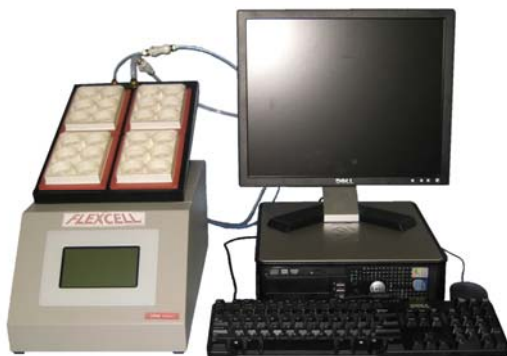
図 4. Flexcell® FX-5000™ Tension System を使用して、3Dの細胞-ゲルのコンストラクトに調節された伸縮力を適用します。
