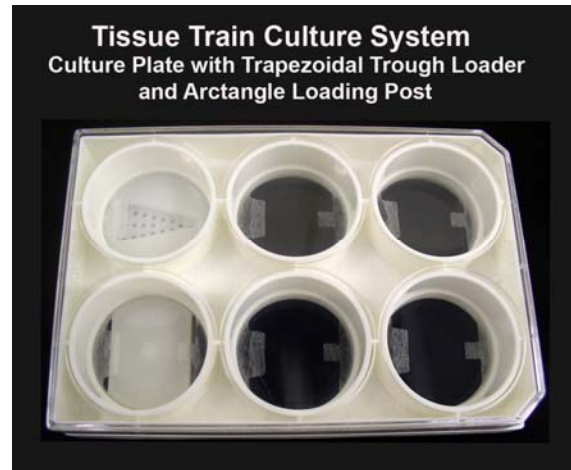
図1. 細胞-マトリックス構築(コンストラクト)3D培養用 Tissue Train® 培養プレート。左上ウェルではフレキシブルメンブレン下にTrapezoidal Trough Loader™ がセットされています。隣接する4ウェルは、一軸性コンストラクトの細胞及びマトリックスを接着させるアンカーを示します。左下ウェルに示すのは、単軸性負荷を適用するための弧形 Arctangle™ ローディングポスト (loading post) です。
